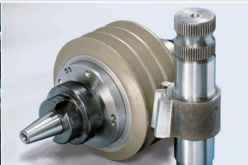
Esmerilhamento CBN especial de um segmento de caixa de direção
